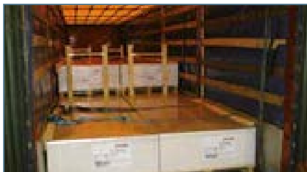
图19托盘上纸张的围板阻挡
