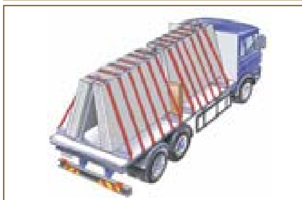
图 63 系固至平台上的板子中使用的阻挡装置安装就位
