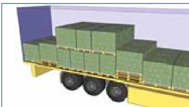
图17对较高层的前方门槛阻挡
