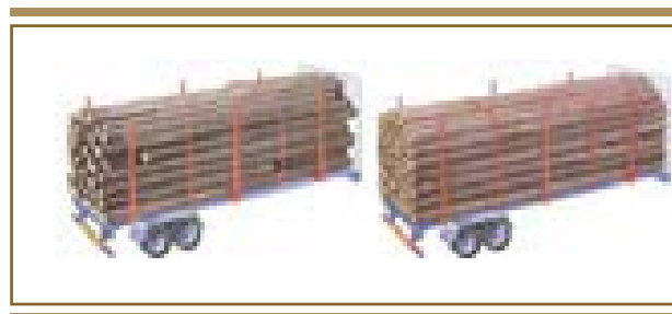
图 66 通常需要进行捆绑增加圆木的垂直荷载
