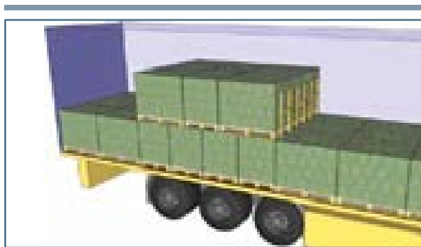
图18第二层货物的前方围板阻挡
