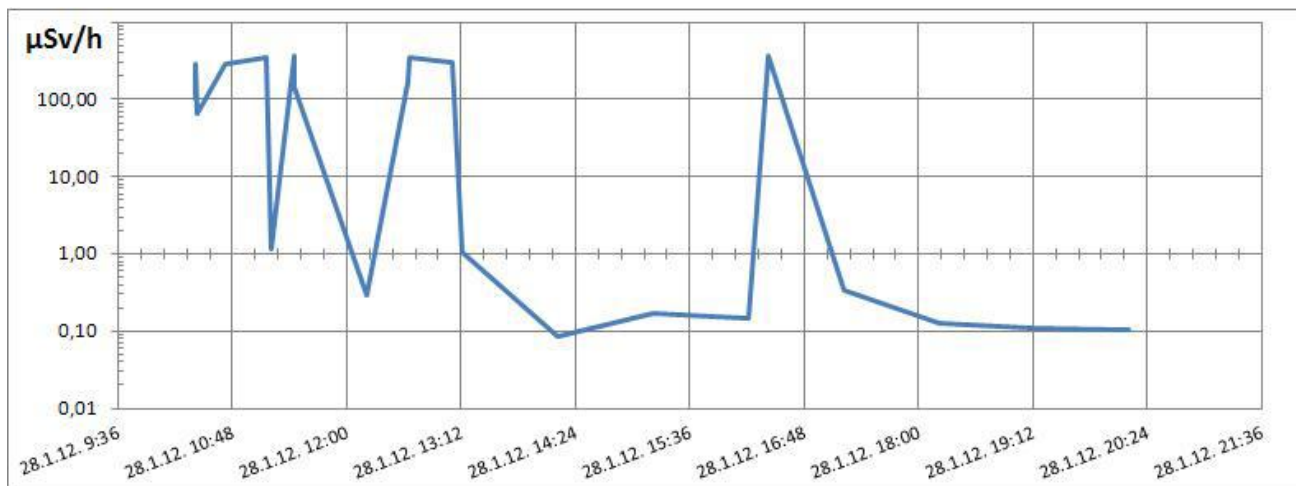
Рисунок 3 – Мощность дозы излучения в зависимости от времени; график показывает частоту и точное время очередного сканирования одного и того же дозиметра.
