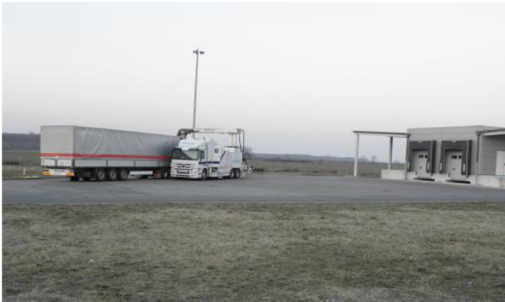
Фотография 4 – Сканирующая установка рентгеновского излучения высокой энергии типа LINAC – 4,5 МэВ, работающая в импульсном режиме. Водитель в кабине остановленного грузовика не находится.
