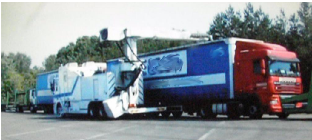
Фотография 5 – Сканирующая установка рентгеновского излучения высокой энергии (типа LINAC – 4,5 МэВ, работающая в импульсном режиме) сканирует надлежащим образом выровненную колонну грузовиков.
