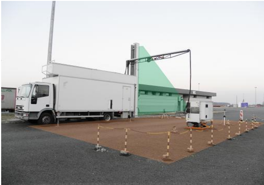
Фотография 3 – Сканер контурного типа – 300 кэВ: рентгеновский инспекционно-досмотровый комплекс с двумя уровнями энергии, работающий в режиме постоянного воздействия. На фотографии показана зона ограничения доступа вокруг комплекса, работающего в режиме сканирования.
