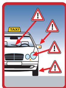
**Tudo em ordem?** Inspeccionou os travões, os pneus (pressão e relevo do piso), o líquido de arrefecimento e o óleo, antes de começar o turno? E os espelhos, as janelas (tem boa visibilidade?), o limpa-pára-brisas e as luzes de iluminação e sinalização? Inspeccione também o equipamento especial, por exemplo o taxímetro, o rádio-telefone e o terminal do sistema de navegação. O veículo apresenta danos aparentes? Está limpo, por dentro e por fora?
