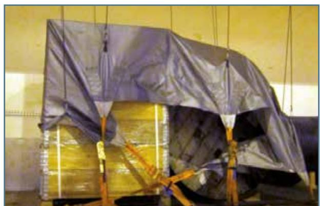
Fig. 42. Système de retenue avec sangles intégrées
