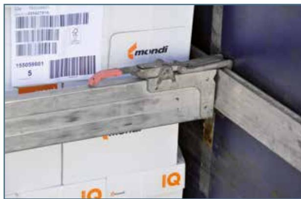
Fig. 44. Planches de blocage intermédiaires
