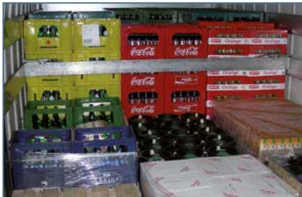
Fig. 13. Blocage par le hayon avant et des portes spécialement conçues à cet effet
