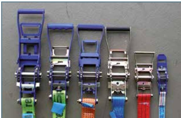
Fig. 37. Différents types de tendeurs à rochet
