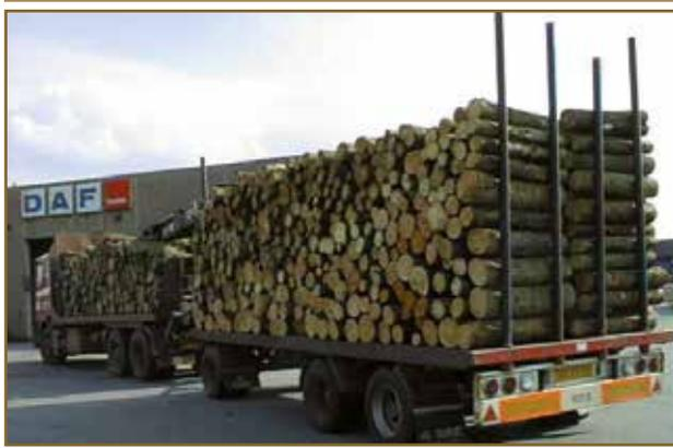
Fig. 69. L'empilage transversal du bois n'est pas recommandé !
