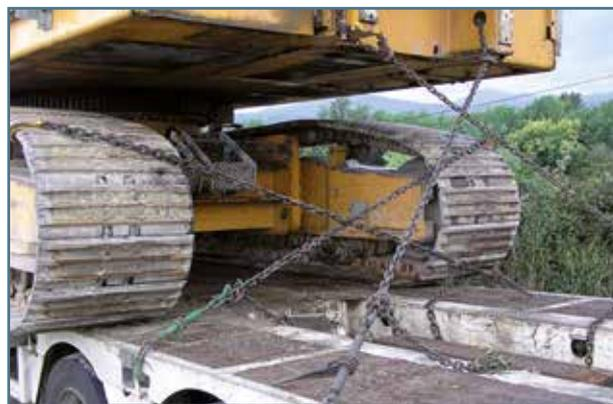
Fig. 39. Excavatrice avec amarrage oblique par chaînes
