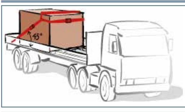
Fig. 26. Exemple d'arrimage arrière empêchant un déplacement vers l'avant
