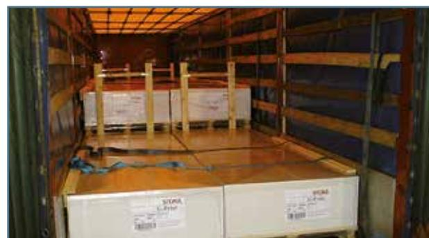
Fig. 19. Blocage par panneaux de feuilles de papier sur des palettes
