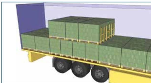
Fig. 18. Blocage par panneaux vers l'avant pour le second étage
