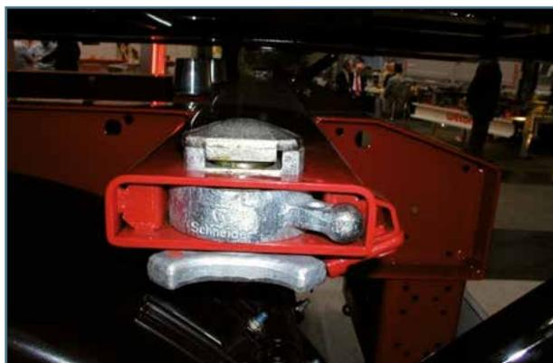
Fig. 46 et Fig. 47. Verrous tournants
