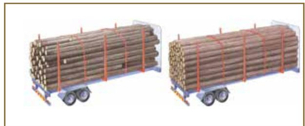
Fig. 66. L'arrimage de la charge doit toujours exercer une pression verticale sur les bois ronds
