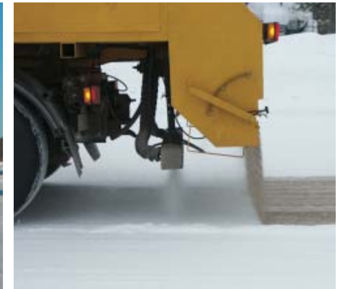
Projection de sable humide par un disque rotatif
