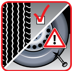
Prüfe die Reifen auf Profil und Beschädigungen (z.B. Undichtheit)
