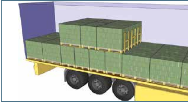
الشكل رقم ١٨: التثبيت بلوحات في الاتجاه الأمامي للطبقة الثانية
