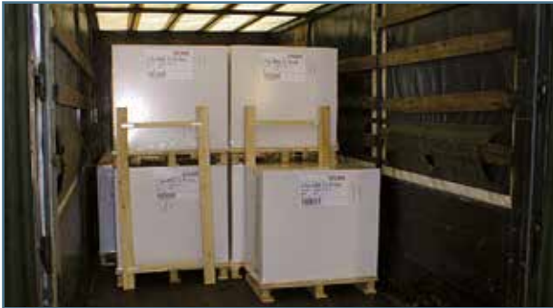
الشكل رقم ١٨: التثبيت بلوحات في الاتجاه الأمامي للطبقة الثانية
