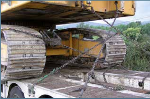
الشكل رقم ٣٩: حفار مربوط بسلاسل بشكل قطري
