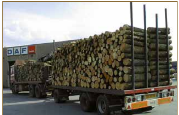
الشكل رقم ٦٩: يوصى بعدم رص الخشب بالعرض!
