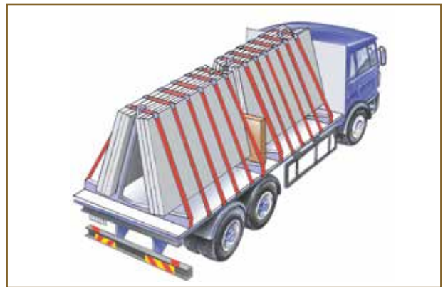
الشكل رقم ٦٣: ألواح مؤمنة على منصة بأدوات تثبيت مناسبة
