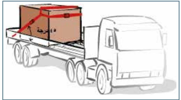
الشكل رقم ٢٦: مثال على ربط بالزنبرك يمنع الحركة للأمام
