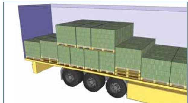
الشكل رقم ١٧: التثبيت الحدي للطبقة العليا في الاتجاه الأمامي
