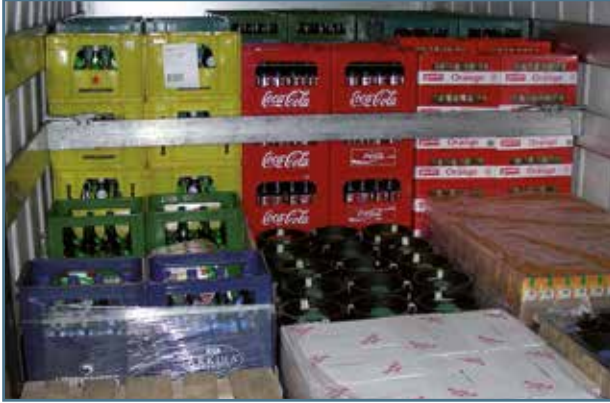
الشكل رقم ١٣: تثبيت باستخدام اللوح الأمامي والبوابات المصممة خصيصاً
