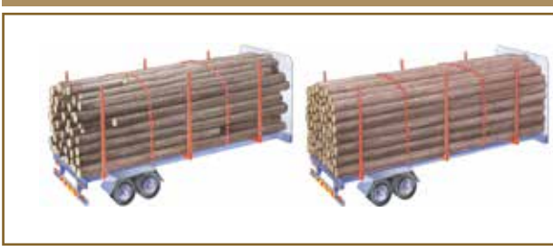
الشكل رقم ٦٦: أربطة الحمولة دائماً تضيف حملاً عمودياً على الخشب الحلقي
